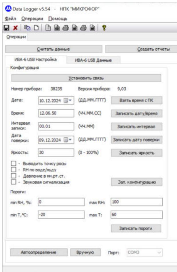
Рис.13. Окно программы **Data Logger** для конфигурирования термогигрометра.
