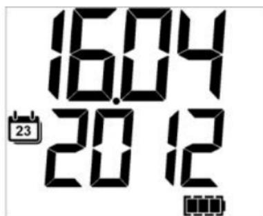
месяц или год), значение которого может увеличиваться на единицу при нажатии на кнопку « $\nabla$ », начинает мигать. Переход к следующему параметру осуществляется при нажатии на кнопку « $\triangleright$ ». После ввода всех параметров на индикаторе высвечивается надпись «ЗАП.». При нажатии кнопки « $\nabla$ » в этом состоянии происходит запись введенных значений текущего времени и даты.
